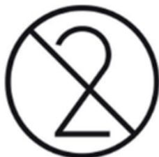
Rysunek 4. Symbol dla filtrów „tylko do jednorazowego użycia” (EN 143:2021)
